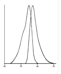
**WAVELENGTH**: EXCITATION 552nm (Maxima) EMISSION 575nm
